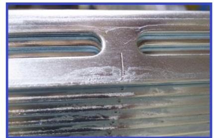
写真1 めっき不良の様子
