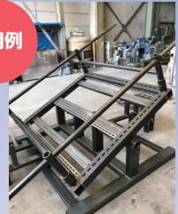
船の上で大波の揺れにより制御盤内の部品等が外れないかを試験する装置です。簡単に言えば大きいシーソーを造るイメージです。しかしこれにも制約が多くあり、全長 3M、巾 800mm くらいで最終的には 500kg の試験品を角度は左右 25 度で止まる様に揺らしたいとのことです。CAD でどの程度の重さに耐えるか演算し、材料の板厚を決めました。制作上の肝は丁寧な溶接加工に尽きる物でした。完成品は 1 t まで耐えるオーバースペックとなっていましたが、お客様には大変喜ばれました。
