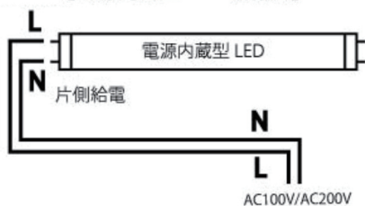
【電源内蔵型 LED 結線図】
