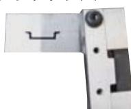
ご使用していくと、切れ味が悪くなったり、バリが大きくなったりすることがあります。刃部を本体から取り外した後、固定刃と可動刃を上下にずらすと、写真の状態になります。固定刃、可動刃が擦れ合う刃面を油砥石（推奨品：株式会社大和製砥所 OIL STONE 細め）でこすり、こびりついたアルミ粕や汚れを落として下さい。
